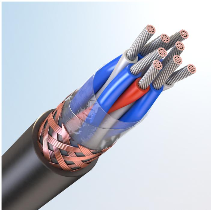
Кабель монтажный, с медными токопроводящими жилами, с изоляцией из поливинилхлоридного пластика, с экраном по группам из медных проволок, бронированный стальными оцинкованными лентами, с наружной оболочкой из поливинилхлоридного пластика
