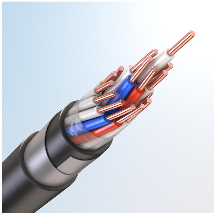
Кабель сигнально-блокировочный, с медными токопроводящими жилами, с изоляцией из полиэтилена, бронированный стальными оцинкованными лентами, с защитным шлангом из полиэтилена
