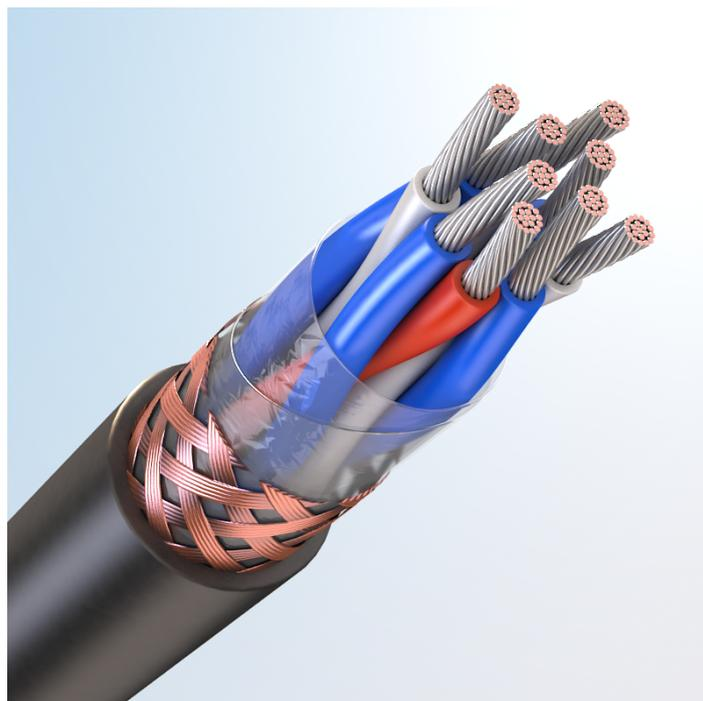
Кабель монтажный, с медными токопроводящими жилами, с изоляцией из поливинилхлоридного пластика, с наружной оболочкой из поливинилхлоридного пластика
