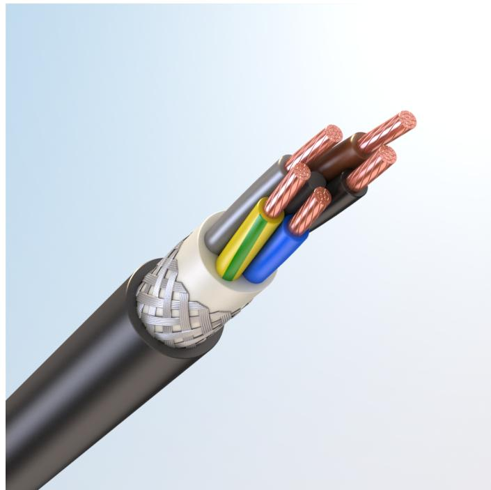
Кабель судовой гибкий, с медными токопроводящими жилами, с изоляцией из высокопрочной этиленпропиленовой резины НЕPR, бронированный стальными оцинкованными проволоками в виде оплетки, с наружной оболочкой из полимерной композиции пониженной пожарной опасности, не содержащей галогенов
