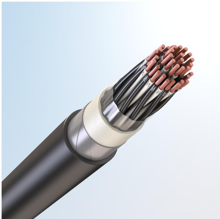
Кабель монтажный универсальный, с медными токопроводящими жилами, с изоляцией из поливинилхлоридного пластиката, бронированный стальными оцинкованными лентами, с наружной оболочкой из поливинилхлоридного пластиката
