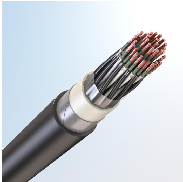
Кабель монтажный универсальный, огнестойкий, с медными токопроводящими жилами, с обмоткой по токопроводящим жилам слюдосодержащей лентой, с изоляцией из поливинилхлоридного пластика, бронированный стальными оцинкованными лентами, с наружной оболочкой из хладостойкого поливинилхлоридного пластика пониженной пожарной опасности, с низким дымо- и газовыделением
