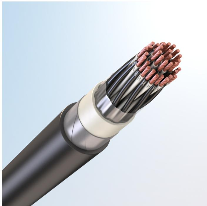
Кабель монтажный универсальный, с медными токопроводящими жилами, с изоляцией из поливинилхлоридного пластика, бронированный стальными оцинкованными лентами, с наружной оболочкой из поливинилхлоридного пластика пониженной пожарной опасности, с низким дымо- и газовыделением
