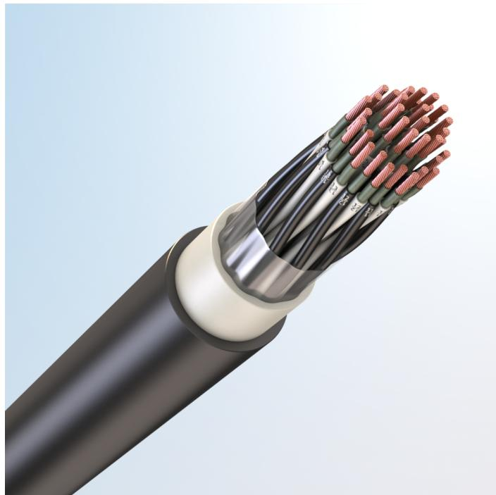
Кабель монтажный универсальный, огнестойкий, с медными токопроводящими жилами, с обмоткой по токопроводящим жилам слюдосодержащей лентой, с изоляцией из поливинилхлоридного пластика, с наружной оболочкой из поливинилхлоридного пластика пониженной пожарной опасности, с низким дымо- и газовыделением
