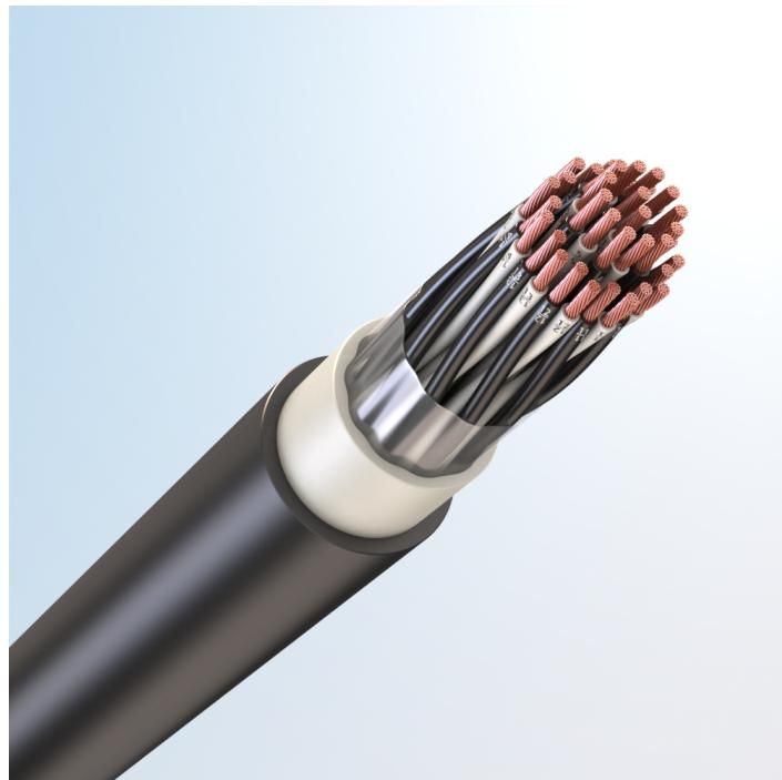
Кабель монтажный универсальный, с медными токопроводящими жилами, с изоляцией из поливинилхлоридного пластика, с наружной оболочкой из хладостойкого поливинилхлоридного пластика пониженной пожарной опасности
