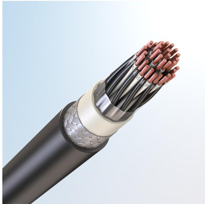
Кабель монтажный универсальный, с медными токопроводящими жилами, с изоляцией из поливинилхлоридного пластика, бронированный стальными оцинкованными проволоками, с наружной оболочкой из поливинилхлоридного пластика пониженной пожарной опасности
