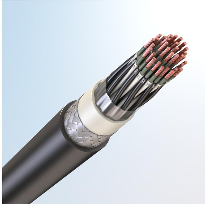
Кабель монтажный универсальный, огнестойкий, с медными токопроводящими жилами, с обмоткой по токопроводящим жилам слюдосодержащей лентой, с изоляцией из поливинилхлоридного пластиката, бронированный стальными оцинкованными проволоками, с наружной оболочкой из хладостойкого поливинилхлоридного пластиката пониженной пожарной опасности, с низким дымо- и газовыделением
