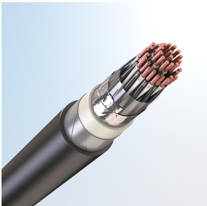
Кабель монтажный универсальный, с медными токопроводящими жилами, с изоляцией из поливинилхлоридного пластиката, с общим экраном из алюмополимерных лент, бронированный стальными оцинкованными лентами, с наружной оболочкой из поливинилхлоридного пластиката пониженной пожарной опасности
