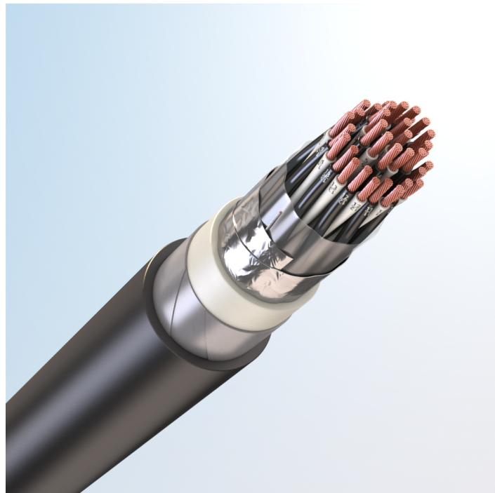
Кабель монтажный универсальный, с медными токопроводящими жилами, с изоляцией из поливинилхлоридного пластика, с общим экраном из алюмополимерных лент, бронированный стальными оцинкованными лентами, с наружной оболочкой из поливинилхлоридного пластика пониженной пожарной опасности, с низким дымо- и газовыделением
