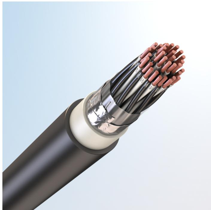
Кабель монтажный универсальный, с медными токопроводящими жилами, с изоляцией из поливинилхлоридного пластика, с общим экраном из алюмополимерных лент, с наружной оболочкой из поливинилхлоридного пластика
