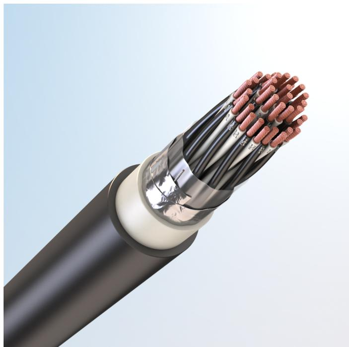
Кабель монтажный универсальный, с медными токопроводящими жилами, с изоляцией из поливинилхлоридного пластиката, с общим экраном из алюмополимерных лент, с наружной оболочкой из хладостойкого поливинилхлоридного пластиката
