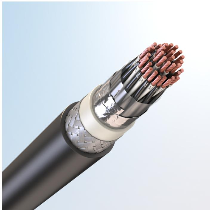
Кабель монтажный универсальный, с медными токопроводящими жилами, с изоляцией из поливинилхлоридного пластика, с общим экраном из алюмополимерных лент, бронированный стальными оцинкованными проволоками, с наружной оболочкой из поливинилхлоридного пластика пониженной пожарной опасности
