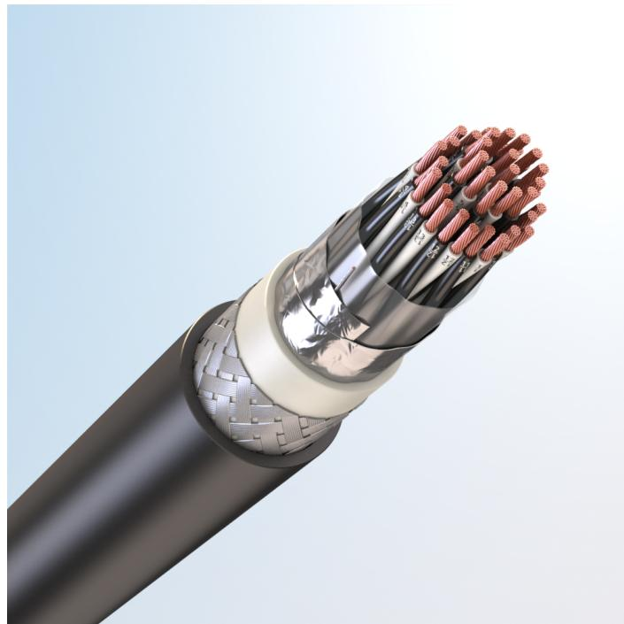
Кабель монтажный универсальный, с медными токопроводящими жилами, с изоляцией из поливинилхлоридного пластика, с общим экраном из алюмополимерных лент, бронированный стальными оцинкованными проволоками, с наружной оболочкой из поливинилхлоридного пластика пониженной пожарной опасности, с низким дымо- и газовыделением
