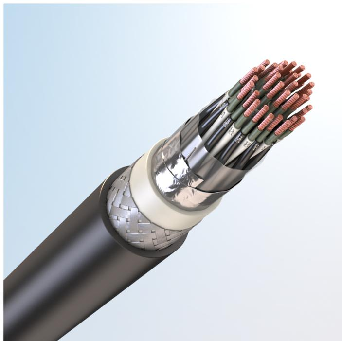
Кабель монтажный универсальный, огнестойкий, с медными токопроводящими жилами, с обмоткой по токопроводящим жилам слюдосодержащей лентой, с изоляцией из поливинилхлоридного пластиката, с общим комбинированным экраном из алюмополимерных лент и медных луженых проволок, бронированный стальными оцинкованными проволоками, с наружной оболочкой из поливинилхлоридного пластиката пониженной пожарной опасности, с низким дымо- и газовыделением
