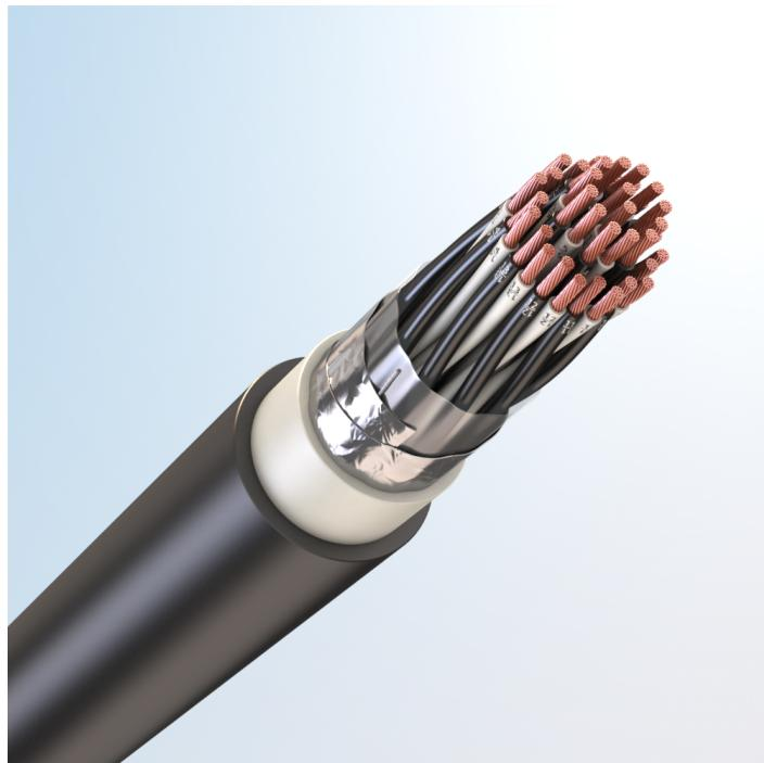
Кабель монтажный универсальный, с медными токопроводящими жилами, с изоляцией из поливинилхлоридного пластика, с общим экраном из медных проволок, с наружной оболочкой из поливинилхлоридного пластика пониженной пожарной опасности, с низким дымо- и газовыделением
