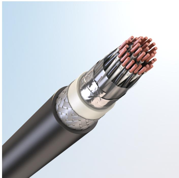
Кабель монтажный универсальный, с медными токопроводящими жилами, с изоляцией из поливинилхлоридного пластика, с общим экраном из медных проволок, бронированный стальными оцинкованными проволоками, с наружной оболочкой из поливинилхлоридного пластика пониженной пожарной опасности, с низким дымо- и газовыделением
