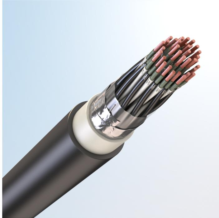
Кабель монтажный универсальный, огнестойкий, с медными токопроводящими жилами, с обмоткой по токопроводящим жилам слюдосодержащей лентой, с изоляцией из поливинилхлоридного пластиката, с общим экраном из медных луженых проволок, с наружной оболочкой из поливинилхлоридного пластиката пониженной пожарной опасности
