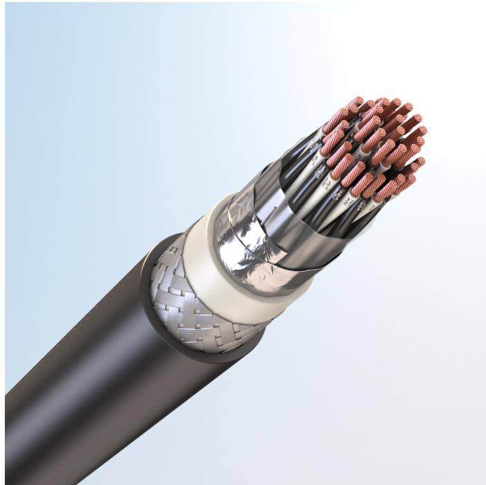
Кабель монтажный универсальный, с медными токопроводящими жилами, с изоляцией из поливинилхлоридного пластика, с общим экраном из медных луженых проволок, бронированный стальными оцинкованными проволоками, с наружной оболочкой из поливинилхлоридного пластика пониженной пожарной опасности
