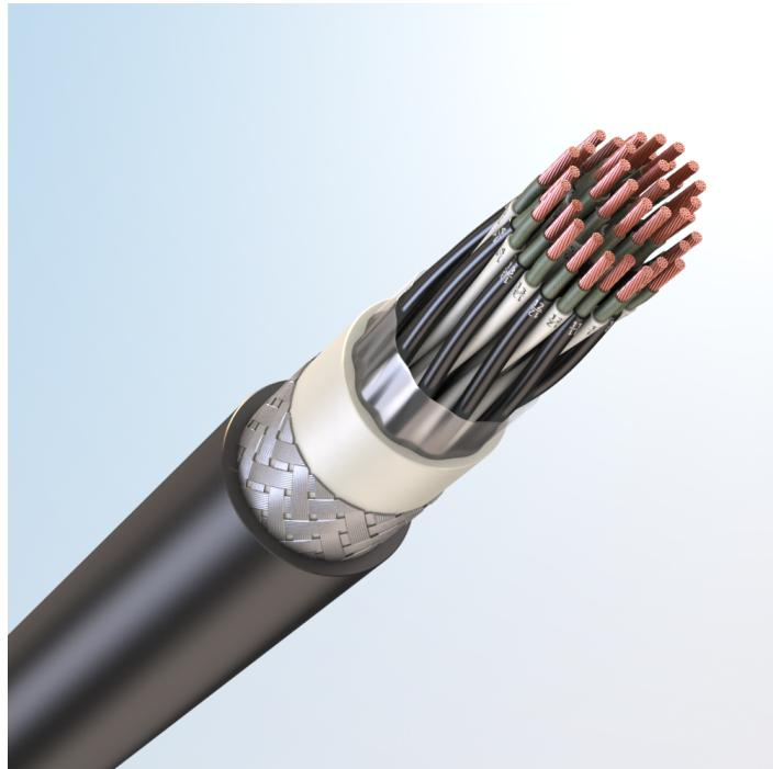
Кабель монтажный универсальный, огнестойкий, с медными токопроводящими жилами, с обмоткой по токопроводящим жилам слюдосодержащей лентой, с изоляцией из полимерной композиции, не содержащей галогенов, бронированный стальными оцинкованными проволоками, с наружной оболочкой из полимерной композиции пониженной пожарной опасности, не содержащей галогенов
