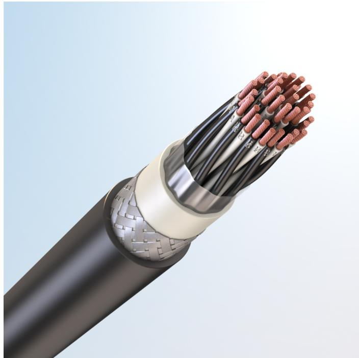
Кабель монтажный универсальный, с медными токопроводящими жилами, с изоляцией из полимерной композиции, не содержащей галогенов, бронированный стальными оцинкованными проволоками, с наружной оболочкой из полимерной композиции пониженной пожарной опасности, не содержащей галогенов
