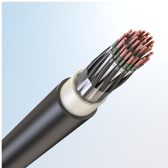
Кабель монтажный универсальный, огнестойкий, с медными токопроводящими жилами, с обмоткой по токопроводящим жилам слюдосодержащей лентой, с изоляцией из полимерной композиции, не содержащей галогенов, с наружной оболочкой из хладостойкой полимерной композиции пониженной пожарной опасности, не содержащей галогенов
