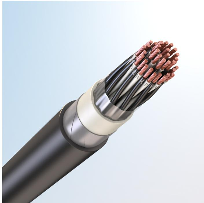
Кабель монтажный универсальный, с медными токопроводящими жилами, с изоляцией из сшитого полиолефина, бронированный стальными оцинкованными лентами, с наружной оболочкой из поливинилхлоридного пластика пониженной пожарной опасности
