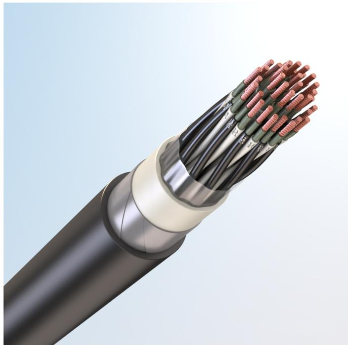
Кабель монтажный универсальный, огнестойкий, с медными токопроводящими жилами, с обмоткой по токопроводящим жилам слюдосодержащей лентой, с изоляцией из сшитого полиолефина, бронированный стальными оцинкованными лентами, с наружной оболочкой из поливинилхлоридного пластика пониженной пожарной опасности
