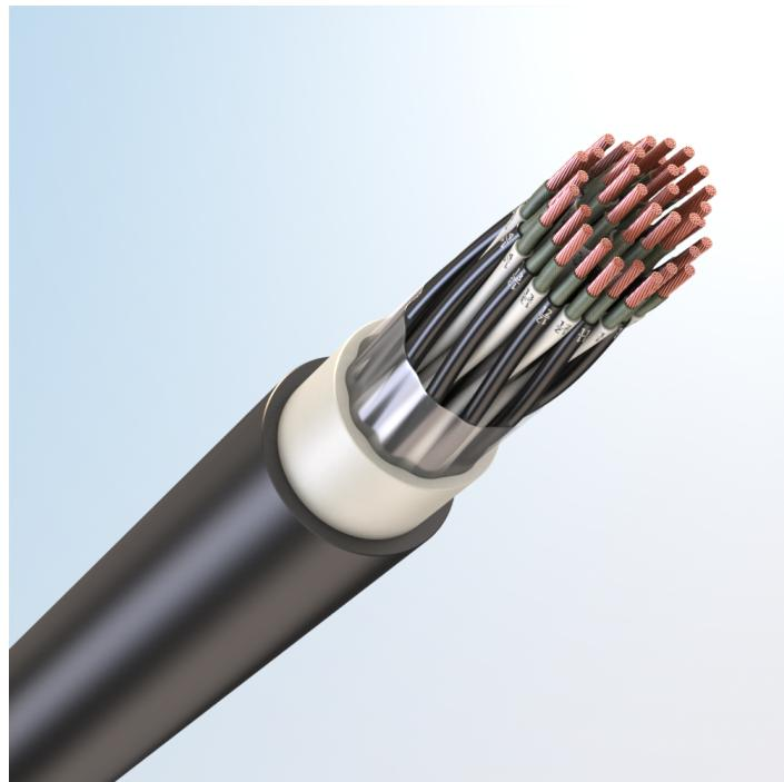
Кабель монтажный универсальный, огнестойкий, с медными токопроводящими жилами, с обмоткой по токопроводящим жилам слюдосодержащей лентой, с изоляцией из свитого полиолефина, с наружной оболочкой из поливинилхлоридного пластика пониженной пожарной опасности, с низким дымо- и газовыделением
