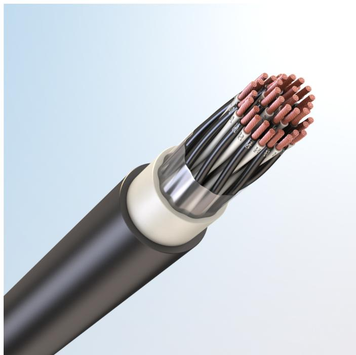
Кабель монтажный универсальный, с медными токопроводящими жилами, с изоляцией из сшитого полиолефина, с наружной оболочкой из хладостойкого поливинилхлоридного пластика пониженной пожарной опасности, с низким дымо- и газовыделением
