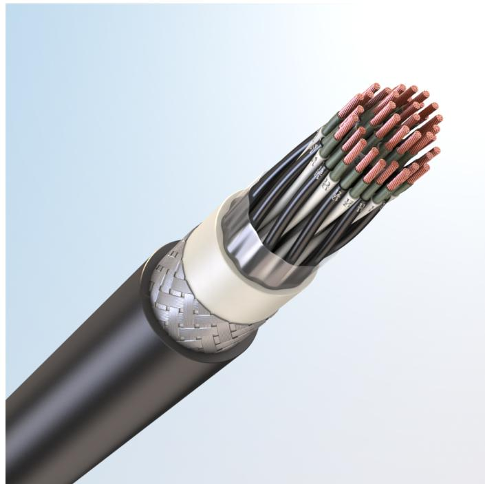
Кабель монтажный универсальный, огнестойкий, с медными токопроводящими жилами, с обмоткой по токопроводящим жилам слюдосодержащей лентой, с изоляцией из сшитого полиолефина, бронированный стальными оцинкованными проволоками, с наружной оболочкой из хладостойкого поливинилхлоридного пластика пониженной пожарной опасности, с низким дымо- и газовыделением
