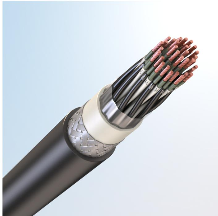
Кабель монтажный универсальный, огнестойкий, с медными токопроводящими жилами, с обмоткой по токопроводящим жилам слюдосодержащей лентой, с изоляцией из сшитого полиолефина, бронированный стальными оцинкованными проволоками, с наружной оболочкой из хладостойкой полимерной композиции пониженной пожарной опасности, не содержащей галогенов
