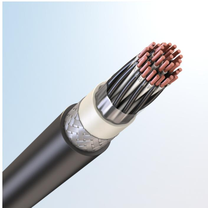
Кабель монтажный универсальный, с медными токопроводящими жилами, с изоляцией из сшитого полиолефина, бронированный стальными оцинкованными проволоками, с наружной оболочкой из полимерной композиции пониженной пожарной опасности, не содержащей галогенов
