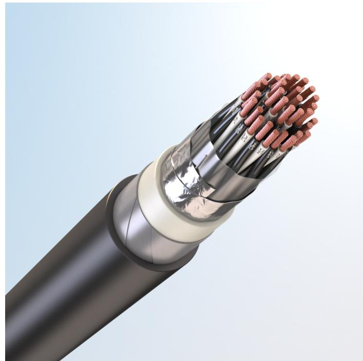
Кабель монтажный универсальный, с медными токопроводящими жилами, с изоляцией из спитого полиолефина, с общим экраном из алюмополимерных лент, бронированный стальными оцинкованными лентами, с наружной оболочкой из хладостойкого поливинилхлоридного пластика пониженной пожарной опасности, с низким дымо- и газовыделением
