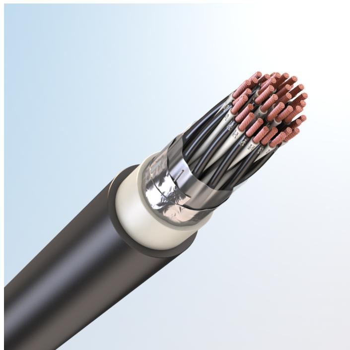
Кабель монтажный универсальный, с медными токопроводящими жилами, с изоляцией из сшитого полиолефина, с общим экраном из алюмополимерных лент, с наружной оболочкой из поливинилхлоридного пластика пониженной пожарной опасности
