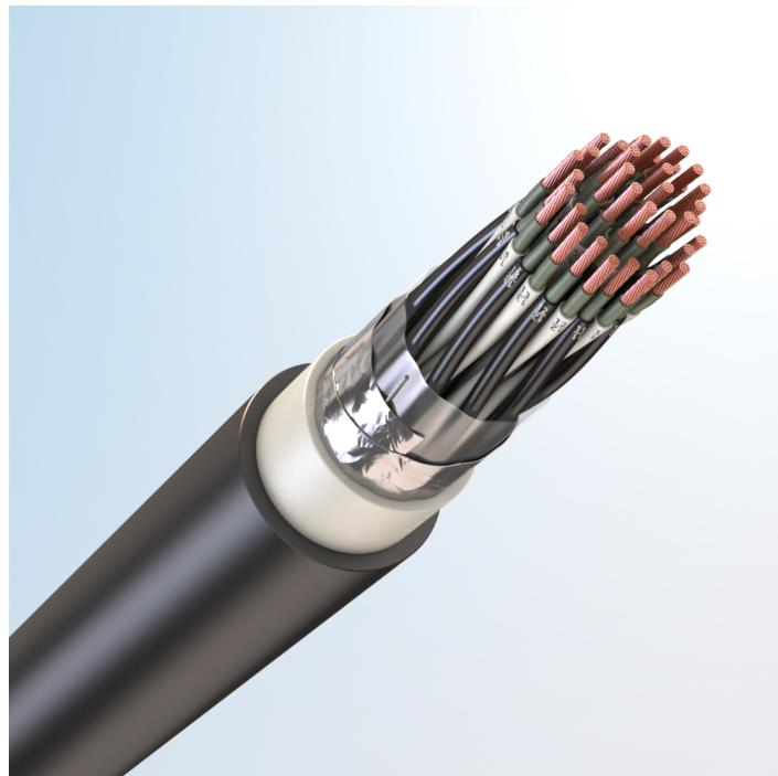
Кабель монтажный универсальный, огнестойкий, с медными токопроводящими жилами, с обмоткой по токопроводящим жилам слюдосодержащей лентой, с изоляцией из свитого полиолефина, с общим экраном из алюмополимерных лент, с наружной оболочкой из поливинилхлоридного пластика пониженной пожарной опасности, с низким дымо- и газовыделением
