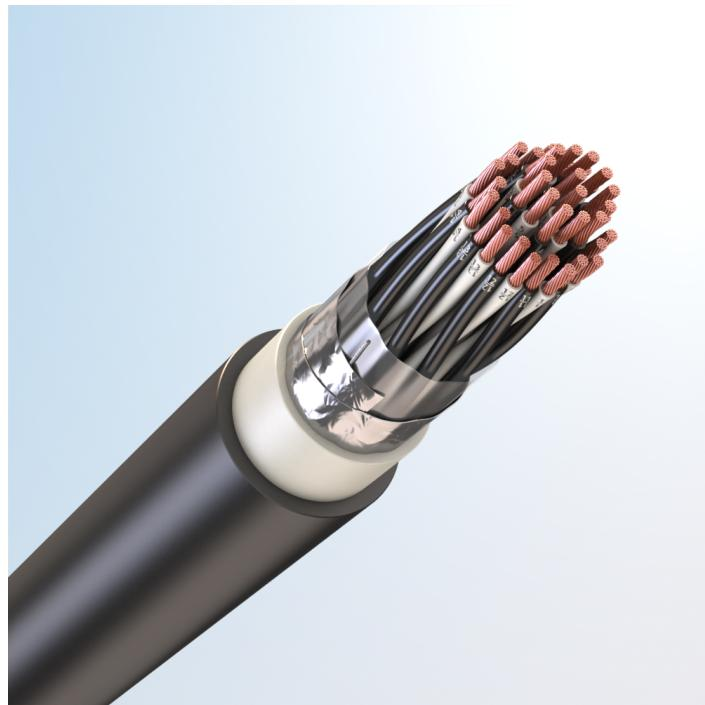
Кабель монтажный универсальный, с медными токопроводящими жилами, с изоляцией из сшитого полиолефина, с общим экраном из алюмополимерных лент, с наружной оболочкой из поливинилхлоридного пластика пониженной пожарной опасности, с низким дымо- и газовыделением
