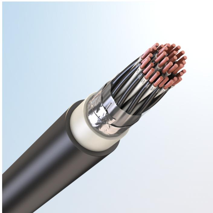
Кабель монтажный универсальный, с медными токопроводящими жилами, с изоляцией из спрессованного полиолефина, с общим экраном из алюмополимерных лент, с наружной оболочкой из хладостойкого поливинилхлоридного пластика пониженной пожарной опасности
