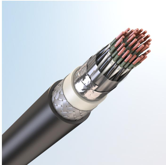
Кабель монтажный универсальный, огнестойкий, с медными токопроводящими жилами, с обмоткой по токопроводящим жилам слюдосодержащей лентой, с изоляцией из свитого полиолефина, с общим экраном из алюмополимерных лент, бронированный стальными оцинкованными проволоками, с наружной оболочкой из хладостойкого поливинилхлоридного пластика пониженной пожарной опасности, с низким дымо- и газовыделением
