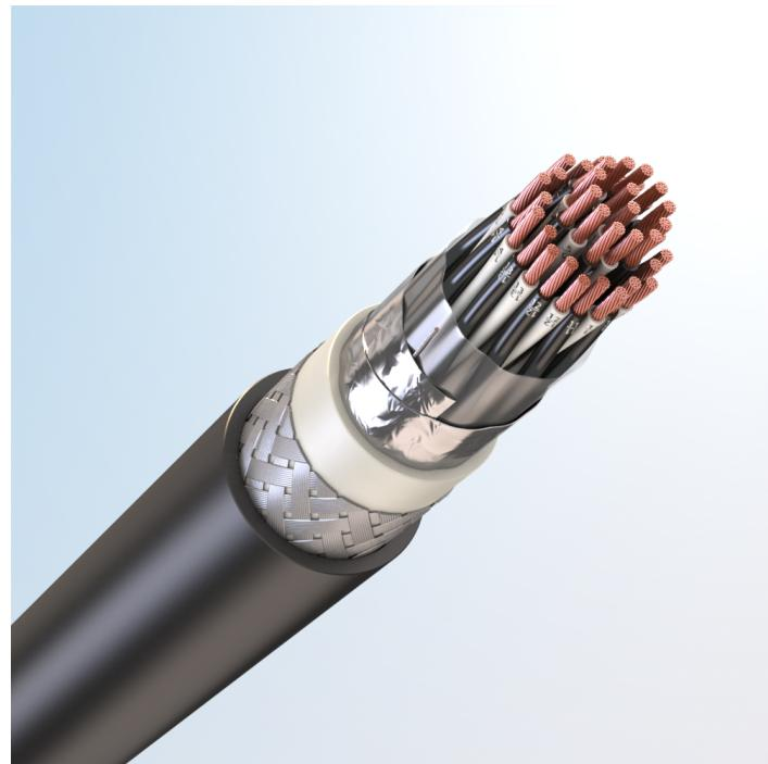
Кабель монтажный универсальный, с медными токопроводящими жилами, с изоляцией из спитого полиолефина, с общим экраном из алюмополимерных лент, бронированный стальными оцинкованными проволоками, с наружной оболочкой из поливинилхлоридного пластика пониженной пожарной опасности, с низким дымо- и газовыделением
