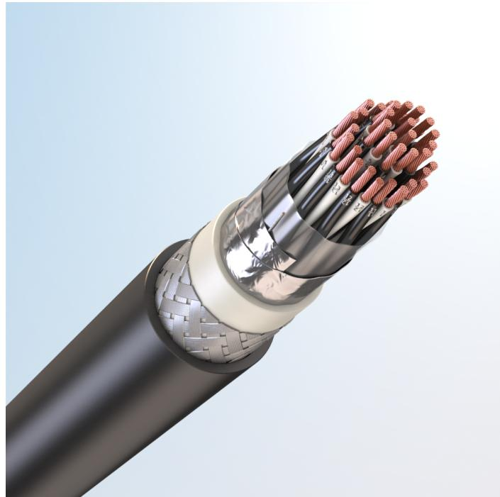
Кабель монтажный универсальный, с медными токопроводящими жилами, с изоляцией из спитого полиолефина, с общим экраном из алюмополимерных лент, бронированный стальными оцинкованными проволоками, с наружной оболочкой из полимерной композиции пониженной пожарной опасности, не содержащей галогенов
