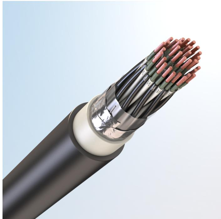
Кабель монтажный универсальный, огнестойкий, с медными токопроводящими жилами, с обмоткой по токопроводящим жилам слюдосодержащей лентой, с изоляцией из свитого полиолефина, с общим экраном из алюмополимерных лент, с наружной оболочкой из полимерной композиции пониженной пожарной опасности, не содержащей галогенов
