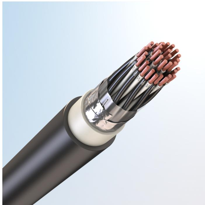
Кабель монтажный универсальный, с медными токопроводящими жилами, с изоляцией из сшитого полиолефина, с общим экраном из медных проволок, с наружной оболочкой из хладостойкого поливинилхлоридного пластика пониженной пожарной опасности
