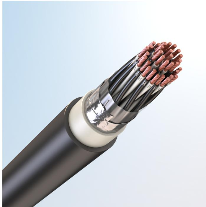
Кабель монтажный универсальный, с медными токопроводящими жилами, с изоляцией из сшитого полиолефина, с общим экраном из медных луженых проволок, с наружной оболочкой из поливинилхлоридного пластика пониженной пожарной опасности
