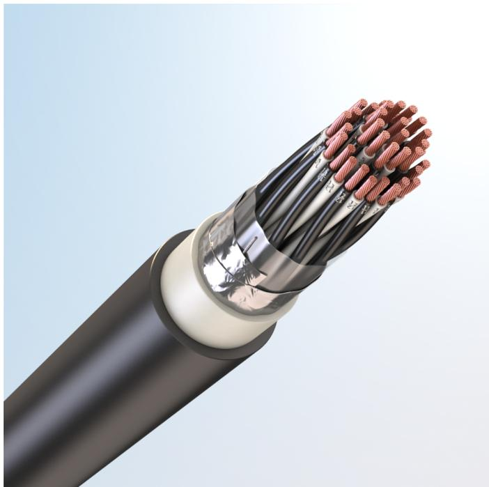
Кабель монтажный универсальный, с медными токопроводящими жилами, с изоляцией из сшитого полиолефина, с общим экраном из медных луженых проволок, с наружной оболочкой из поливинилхлоридного пластиката пониженной пожарной опасности, с низким дымо- и газовыделением
