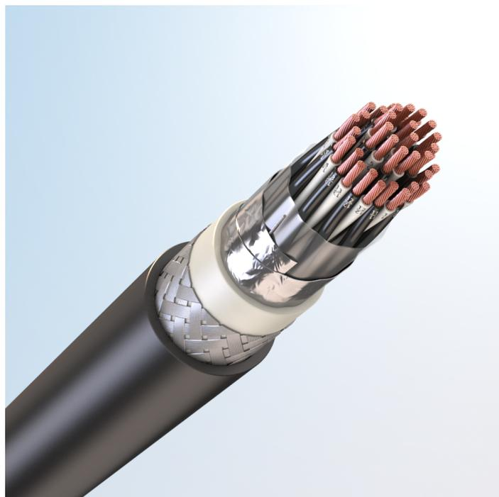
Кабель монтажный универсальный, с медными токопроводящими жилами, с изоляцией из сшитого полиолефина, с общим экраном из медных луженых проволок, бронированный стальными оцинкованными проволоками, с наружной оболочкой из поливинилхлоридного пластика пониженной пожарной опасности, с низким дымо- и газовыделением
