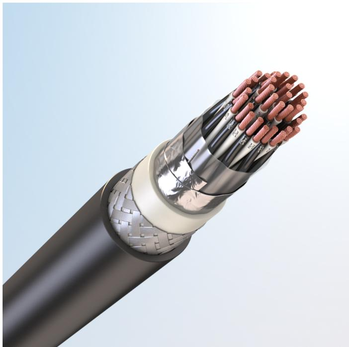
Кабель монтажный универсальный, с медными токопроводящими жилами, с изоляцией из сшитого полиолефина, с общим экраном из медных луженых проволок, бронированный стальными оцинкованными проволоками, с наружной оболочкой из хладостойкого поливинилхлоридного пластика пониженной пожарной опасности, с низким дымо- и газовыделением
