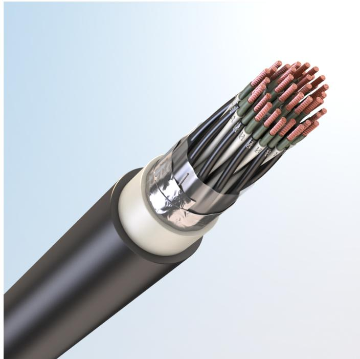
Кабель монтажный универсальный, огнестойкий, с медными токопроводящими жилами, с обмоткой по токопроводящим жилам слюдосодержащей лентой, с изоляцией из свитого полиолефина, с общим экраном из медных проволок, с наружной оболочкой из полимерной композиции пониженной пожарной опасности, не содержащей галогенов
