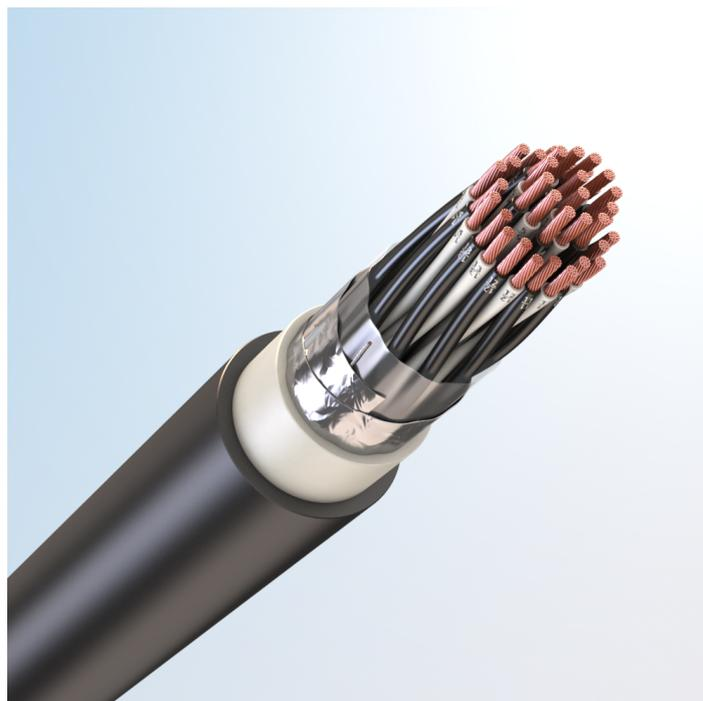
Кабель монтажный универсальный, с медными токопроводящими жилами, с изоляцией из сшитого полиолефина, с общим экраном из медных проволок, с наружной оболочкой из хладостойкой полимерной композиции пониженной пожарной опасности, не содержащей галогенов
