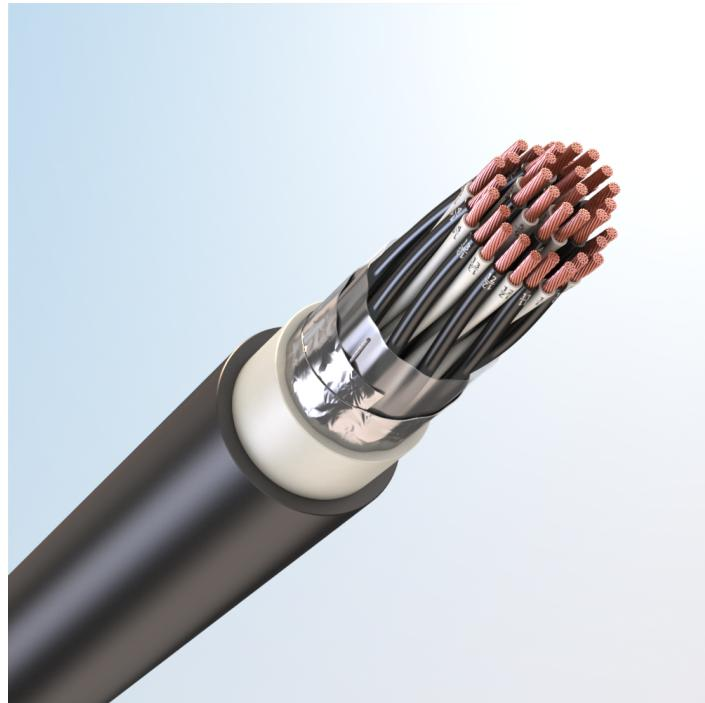
Кабель монтажный универсальный, с медными токопроводящими жилами, с изоляцией из полимерной композиции, не содержащей галогенов, с общим экраном из алюмополимерных лент, с наружной оболочкой из хладостойкой полимерной композиции пониженной пожарной опасности, не содержащей галогенов
