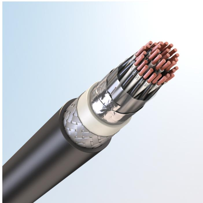
Кабель монтажный универсальный, с медными токопроводящими жилами, с изоляцией из полимерной композиции, не содержащей галогенов, с общим экраном из медных проволок, бронированный стальными оцинкованными проволоками, с наружной оболочкой из полимерной композиции пониженной пожарной опасности, не содержащей галогенов
